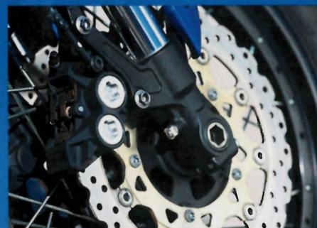
▲ La Super Ténéré est pourvue d'un freinage couplé UBS (Unified Brake System) à répartition hydro-électronique, où l'action sur le levier commande également l'étrier arrière (mais pas l'inverse).
