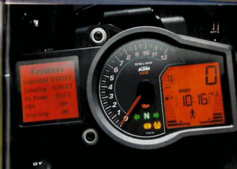
▲ C'est le plus riche de tous ! Entièrement pilotable depuis le commodo gauche, ce bloc compteurs est de plus paramétrable. Dommage qu'il ne soit pas plus séduisant à l'œil...
