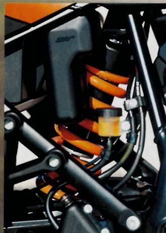
◀ KTM singe BMW avec son système de suspensions à commande électronique baptisé EDS (Electronic Damping System). À chaque mode moteur correspond un tarage spécifique, modifiable depuis le guidon.
