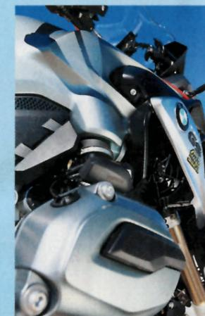
◀ Le flat-twin s'offre une alimentation verticale (les tubes d'échappement sont aujourd'hui situés sous le bloc) ainsi qu'un refroidissement liquide partiel. Les radiateurs sont planqués dans les écopes latérales.
