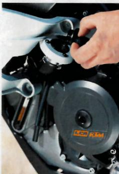
◀ Le niveau d'huile du bloc LC8 est facilement vérifiable grâce à la jauge longitudinale. Il est tout aussi aisé d'effectuer un appoint via ce bouchon idéalement situé.
